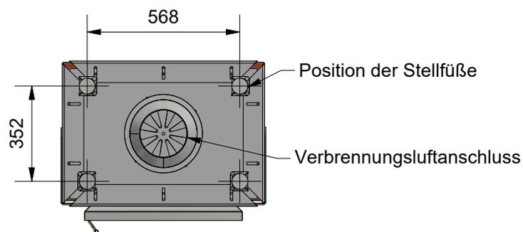
Alle Höhenangaben gelten bei einer Mörtelfugenstärke von 3 mm, einer Fasermattenstärke von 3 mm (im zusammengesetzten Zustand) und vollständig nach unten geschraubtem Grundgestell.
